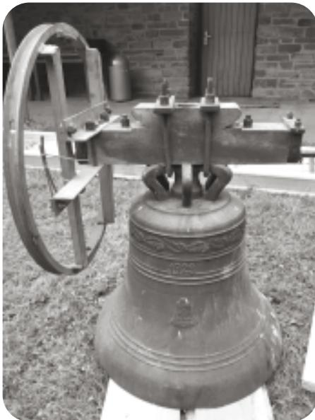
Links: Seilrad zur Aufnahme der Kette als Antriebsverbindung zur Läutemaschine
